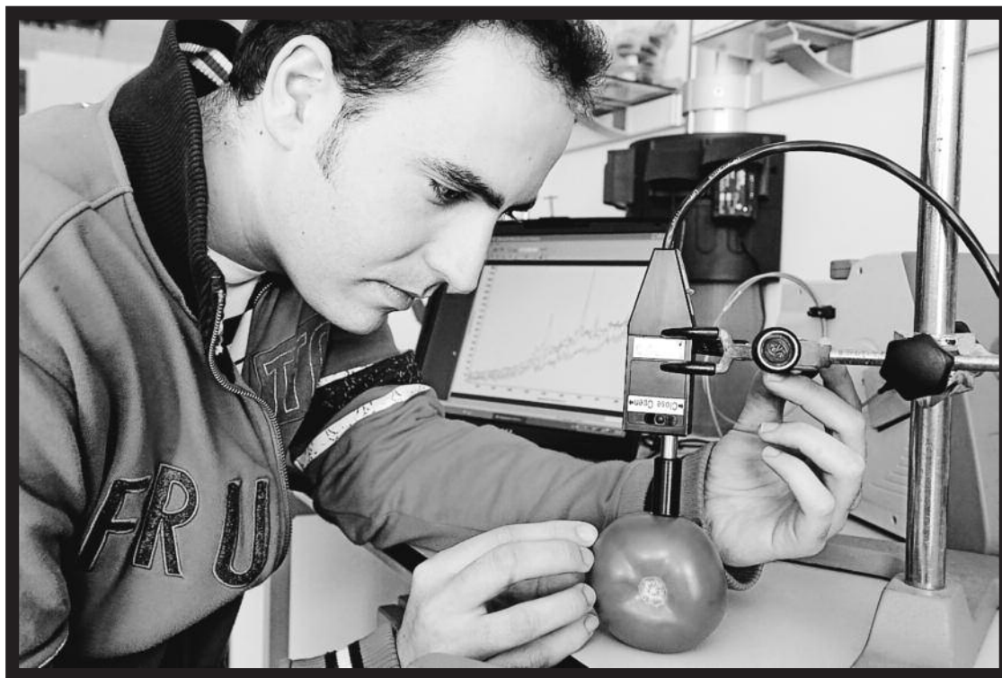
Josu Trebolazabala, EHUko Kimika Analitikoa sailko IBeA ikerketa taldeko kidea, tomate baten osaera aztertzen Raman espektrometroarekin. TXETXU BERRUEZO
