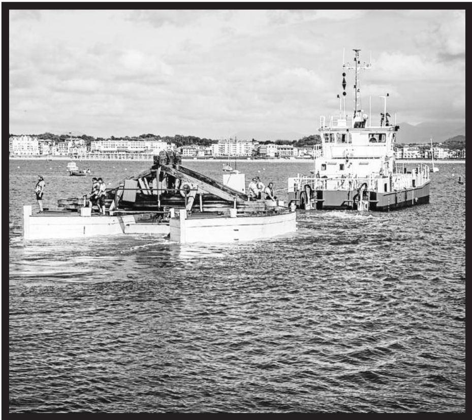
Goian, Arthako kai-muturra, Zokoa eta bertako gotorlekua atzean direla. Behean, «Babeslea» itsasontzia, blokea erdian daramaten bi gabarretatik tiraka. Isabelle MIQUELESTORENA
