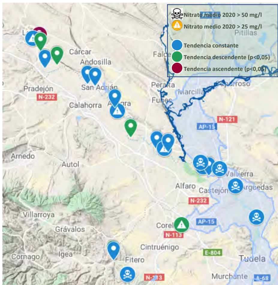
Figura 3. Resumen del Estudio de tendencias de nitratos en aguas subterráneas de estaciones de control asociadas al Ebro
